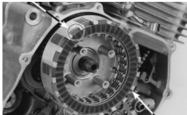
DISCO DEL EMBRAGUE EXTERNO
